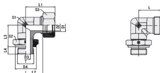
Gänga BSPP med o-ring och stödring
